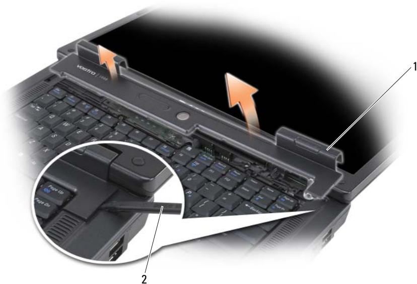
1 Cubierta con bisagras 2 Punta trazadora
