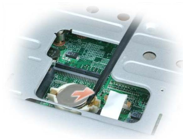
Cuando vuelva a colocar la batería, insértela en un ángulo de 30 grados, por debajo del gancho, con el lado positivo (identificado por un símbolo de suma [+]) hacia arriba y, a continuación, presione sobre ella para colocarla en su sitio.
