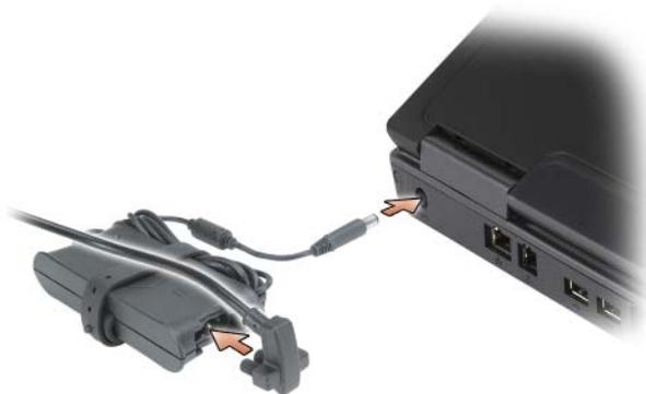
**⚠ PRECAUCIÓN:** el adaptador de CA funciona con tomas de alimentación eléctrica de todo el mundo. No obstante, los conectores de alimentación y los enchufes múltiples varían de un país a otro. El uso de un cable incompatible o la conexión incorrecta del cable al enchufe múltiple o a la toma eléctrica puede dañar el equipo o provocar un incendio.
